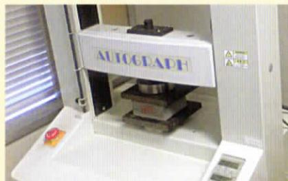
材料の圧縮試験
